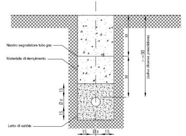
Sezione tipo per posa tubo gas
